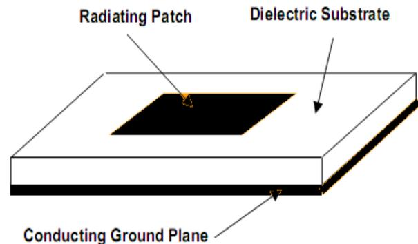
Fig. 1. Patch Antenna
